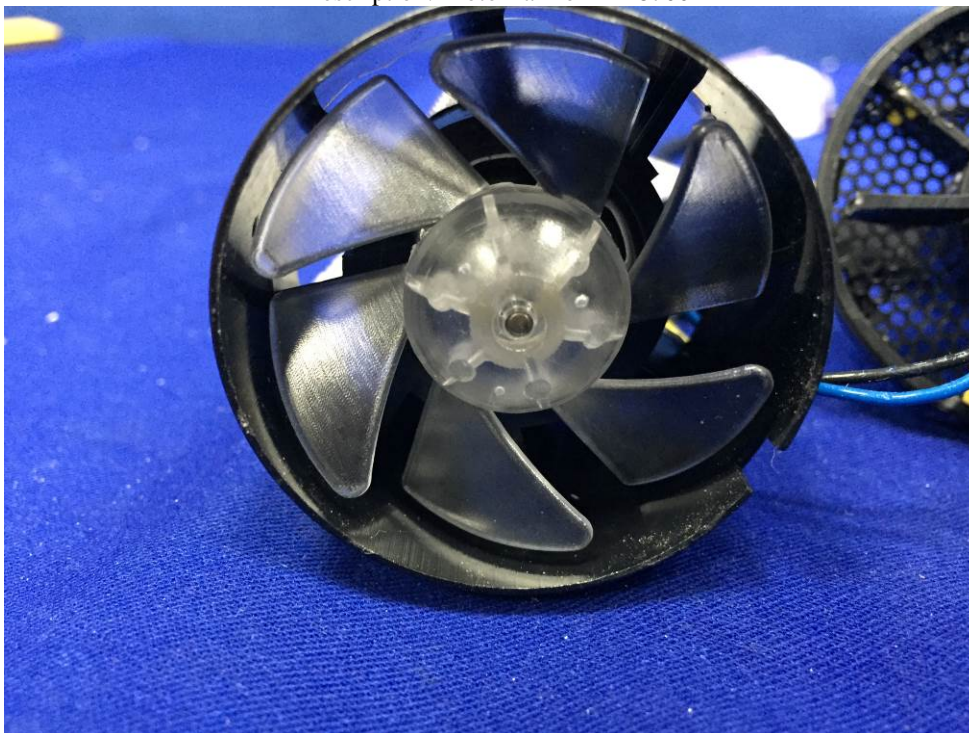
Description: Motor fan for HT-8700
